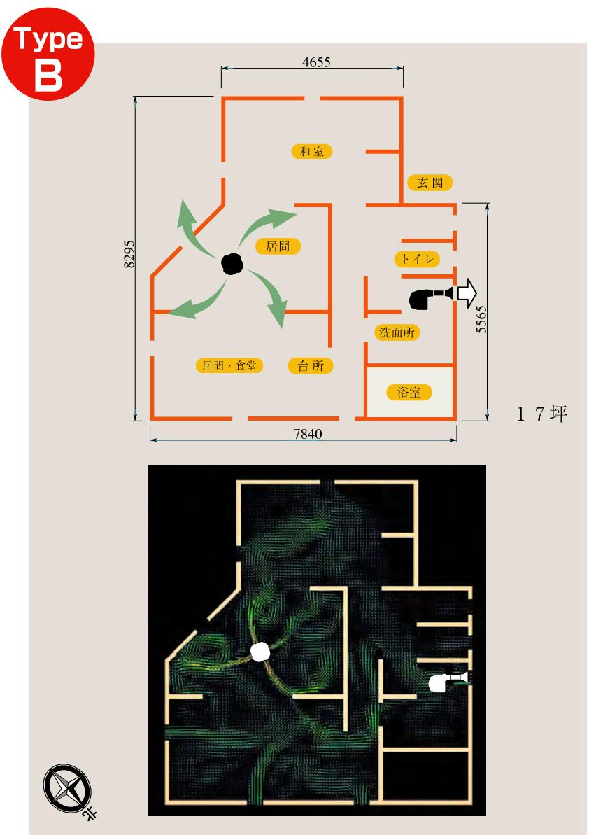
独立した空間のよどみを無くすよう積極的に攪拌して風の流れを作る設置法
