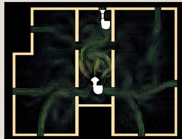
左右の独立した空間から、拡散型の吸込み力を利用し、中央に集約して排気型をアシストする設置法
