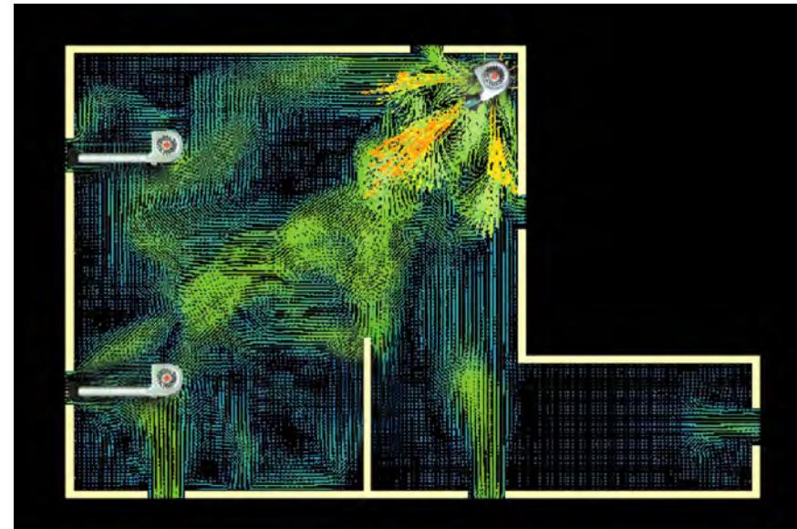
**④排気+拡散** (ブロワー型・2台、拡散型・1台)
